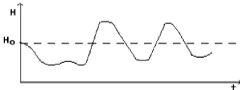
**Figura 1.3.31 Evolución de presión en un transitorio sin separación de columna**
