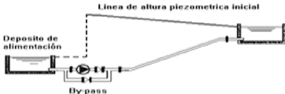
Figura 1.3.50 By-pass en una planta de bombeo.
