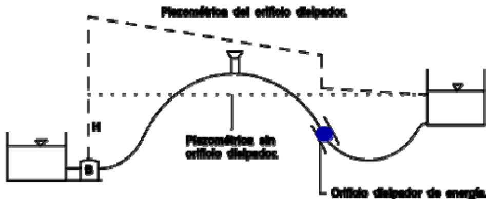
**Figura 1.3.20 Ubicación de orificios disipadores en flujos con gasto parcial.**
