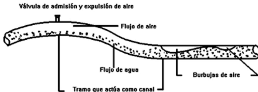
Figura 1.3.19 Operación como canal de una sección.
