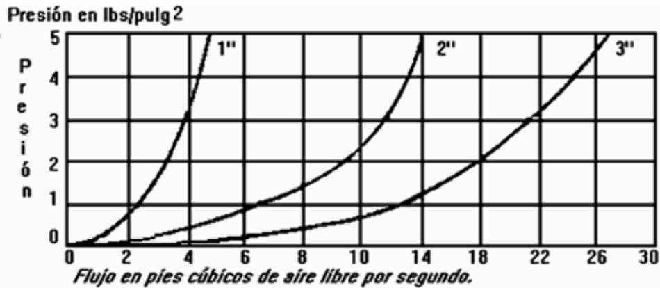
Figura 1.3.3 Curvas de funcionamiento de válvulas de admisión y expulsión de aire con orificios de 1" a 3"
